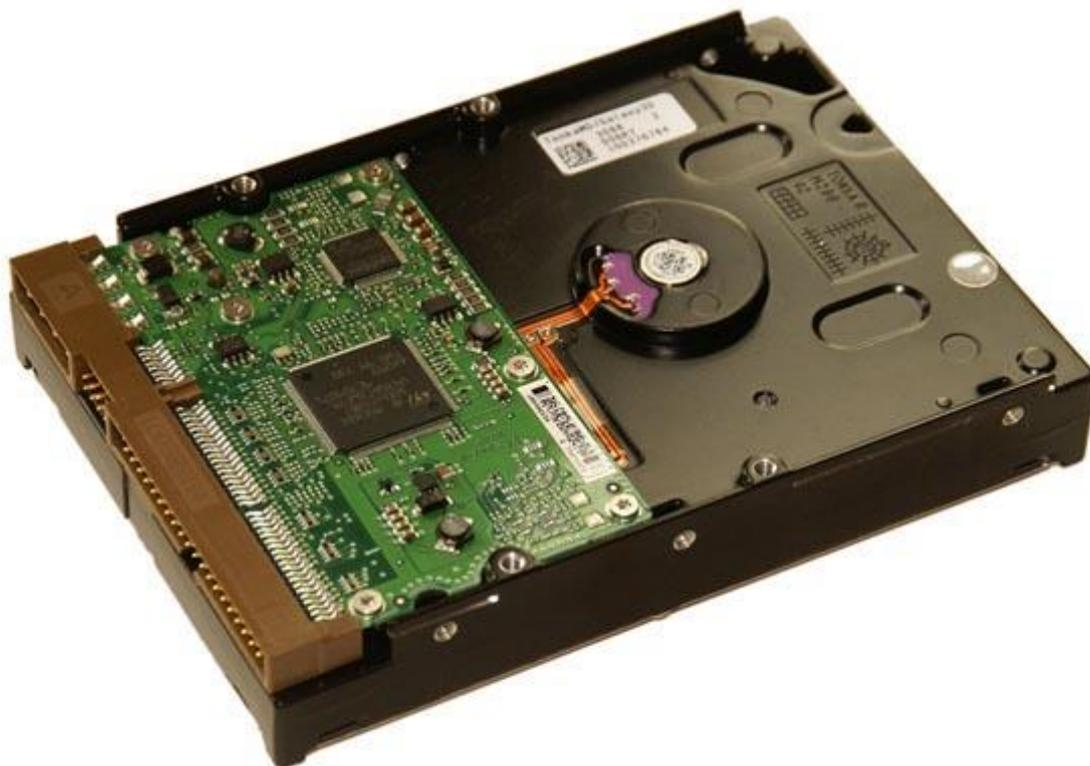
تقریباً هر کامپیوتر رومیزی و سرور دارای یک یا چند هارد دیسک میباشد. هر پردازنده مرکزی و سوپر کامپیوتر در حالت عادی به صدها عدد از این هارد دیسک متصل است. امروزه دستگاههای زیادی را می توان یافت که تا چندی پیش از نوار (Tape) استفاده میکردند ولی حال از هارد دیسک استفاده میکنند. این تعداد انبوه از هارد دیسکها یک کار را به خوبی انجام میدهند. آنها اطلاعات دیجیتال را به یک فرم تقریباً همیشگی ذخیره میکنند. آنها این توانایی را به کامپیوترها می دهند تا در هنگامی که برق میرود اطلاعات خود را بیاد بیاورند.
