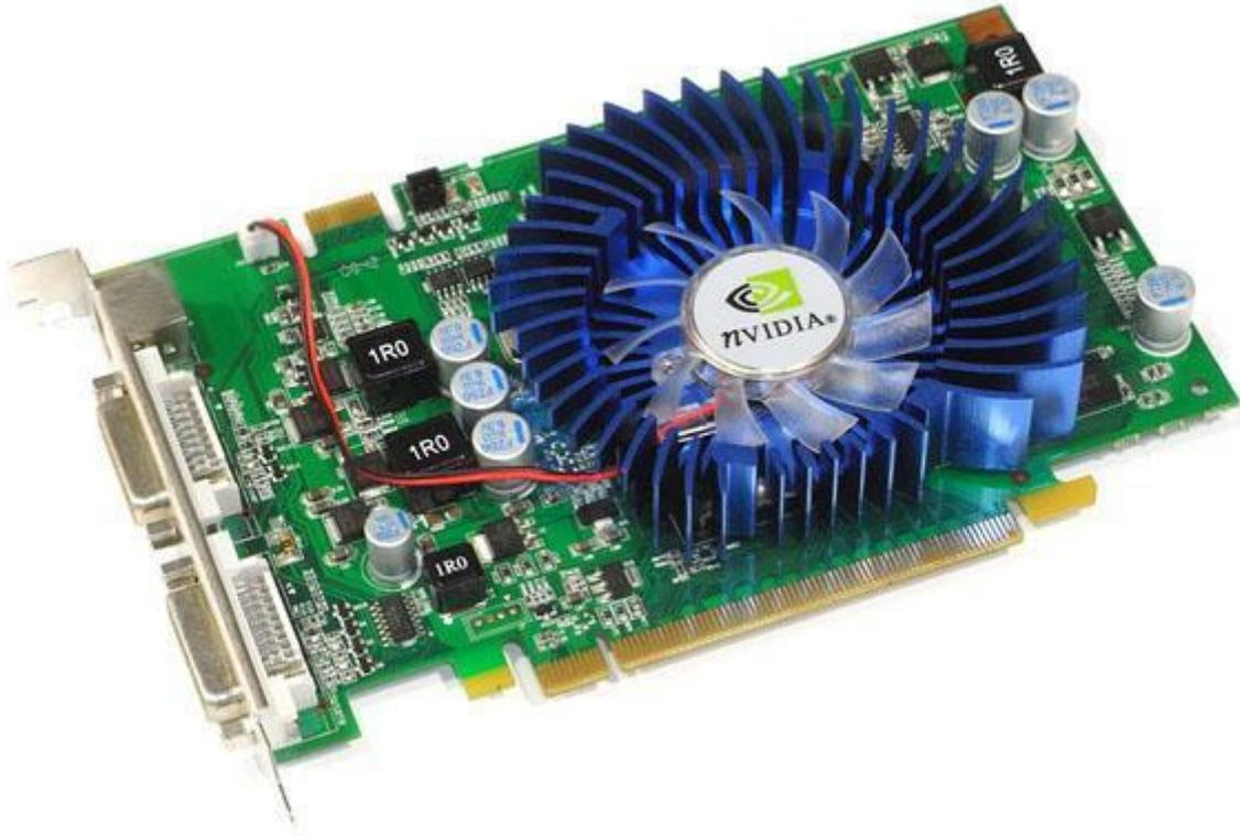
کارت گرافیک در کامپیوتر شخصی دارای جایگاهی خاص است . کارت های فوق اطلاعات دیجیتال تولید شده توسط کامپیوتر را اخذ و آنها را بگونه ای تبدیل می نمایند که برای انسان قابل مشاهده باشند. در اغلب کامپیوترها ، کارت های گرافیک اطلاعات دیجیتال را برای نمایش توسط نمایشگر ، به اطلاعات آنالوگ تبدیل می نمایند. در کامپیوترهای Laptop اطلاعات، همچنان دیجیتال باقی خواهند ماند چون کامپیوترهای فوق اطلاعات را بصورت دیجیتال نمایش می دهند.
